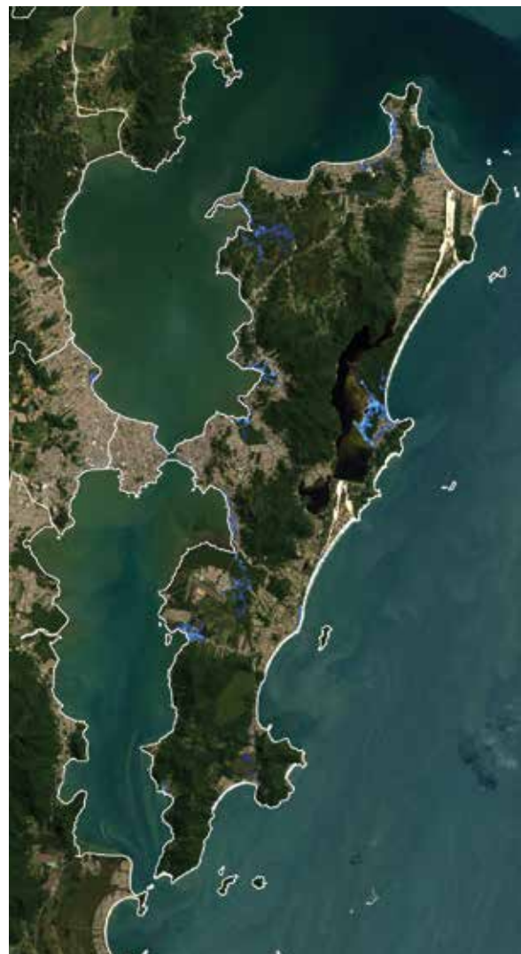
Figura 5.17: Mancha de inundação obtida para os cenários de PR de 10 anos com clima atual
